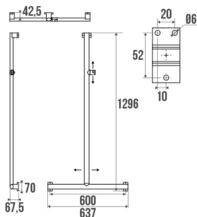
Tube elliptique 38x25 mm en aluminium époxy blanc. Cache-fixations en résine de synthèse blancs.
