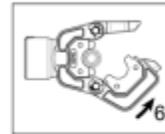
Placer l'ensemble à sertir dans la tête de l'outil en positionnant la bague au milieu de la matrice située côté piston (fig.6).
