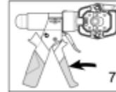
Refermer la tête en poussant sur la crosse, puis pomper jusqu'au "clac" audible en actionnant la poignée mobile (fig.7 et 8).
