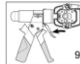
Effectuer les autres sertissages de la même façon. Pour démonter les matrices, ouvrir la tête de sertissage et enlever d'abord la matrice se trouvant sur la crosse. Après utilisation, essuyer soigneusement l'outil et le ranger dans son coffret
