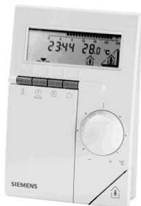
Appareil d'ambiance QAW70 avec sonde d'ambiance, horloge de programmation, réglage de la consigne et correction de la température ambiante (par bouton de réglage)
