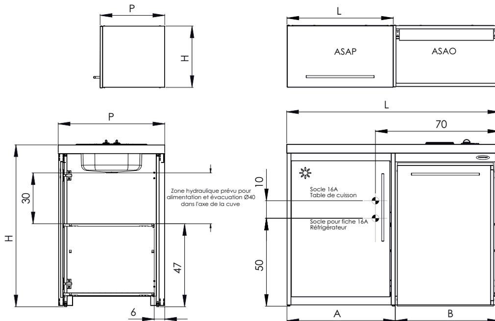
Attention : la place disponible derrière le réfrigérateur ne permet en aucun cas la pose de réseaux apparents d'eau ou d'électricité. Pour y remédier utilisez le kit d'installation (en option)
